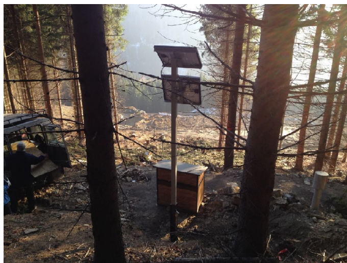
Obr.4 - Napájení systému fotovoltaickým panelem
