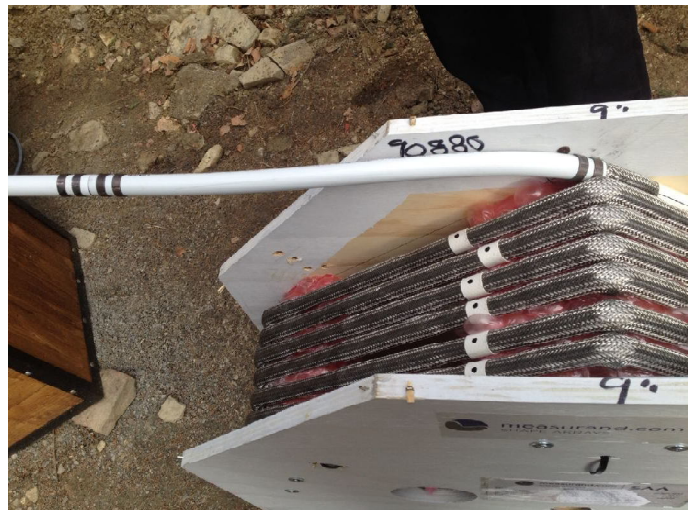
Obr.1 - Snímač SAA 34 kusů 50 -ti cm segmentů je přepravován na speciálním bubnu, celková délka SAA je 17 metrů
